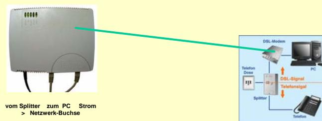
**DSL Modem** ist ein Modem zur Übertragung von Daten über eine DSL-Leitung. Das *DSL-Modem* bildet den (Netz-) Abschluss für die DSL-Leitung.
